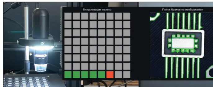
Рис. 6. Визуализация ограничивающих рамок обнаруженных дефектов (см. правую часть изображения)
