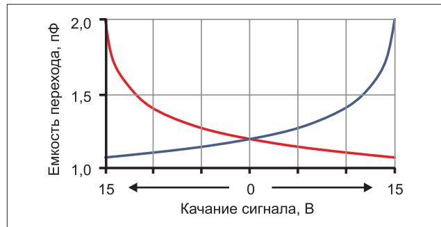
Рис. 4. Изменение емкости двух диодов (см. рис. 2) при качании сигнала
