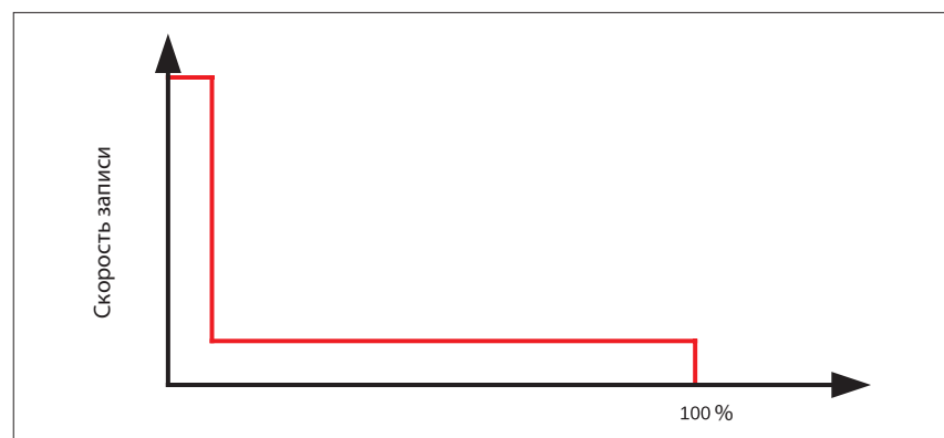
Рис. 2. Последовательная запись с использованием кэша pSLC
