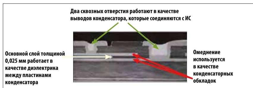
Рис. 2. Эта более надежная технология позволяет решить многие проблемы проектирования печатных плат и обеспечить подачу питания при той же и даже меньшей стоимости
