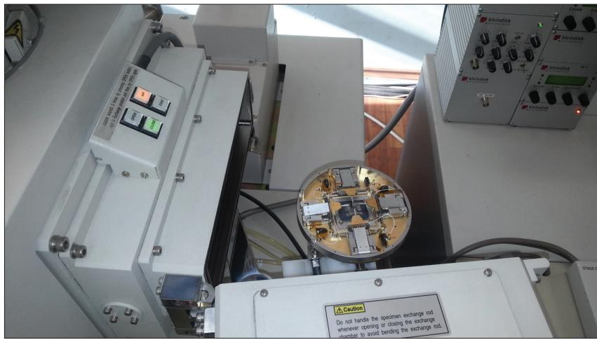
Рис. 5. Загрузка зондодержателя в РЭМ S-4800
