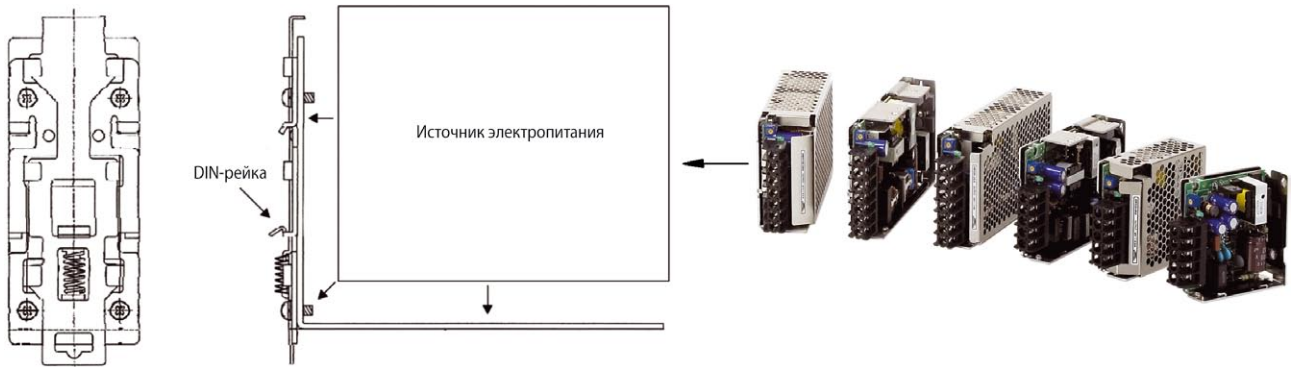
Рис. 2. Схема установки источника электропитания серии HWS на DIN-рейку при помощи DIN-rail bracket
