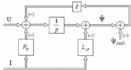
Рис. 13. Структурная схема наблюдателя потокосцепления
