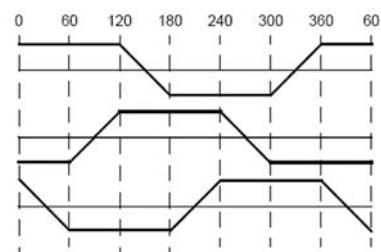
Рис. 3. Линейные ЭДС бесконтактного двигателя постоянного тока
