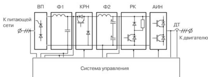
Рис. 7. Функциональная схема силовой части электрического преобразователя БДПТ
