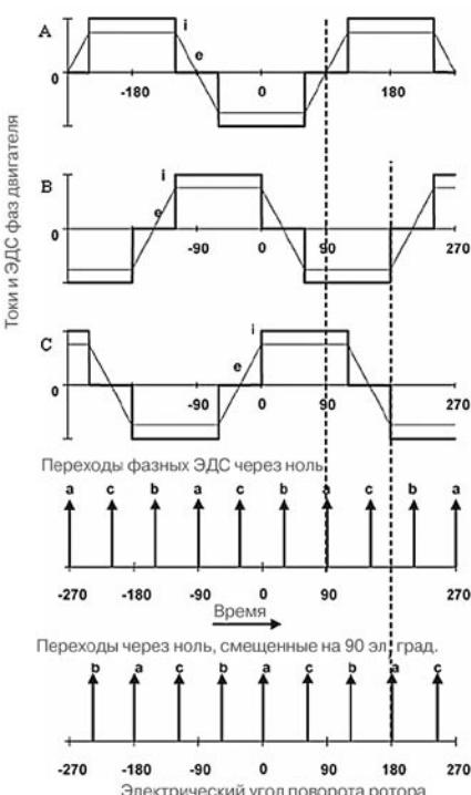
Рис. 8. К принципу «бездатчикового» управления коммутатором БДПТ
