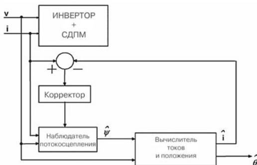
Рис. 12. Структурная схема вычислителя положения ротора ВД
