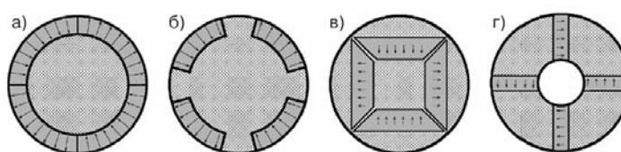
Рис. 5. Различные конструкции ротора БДПТ
