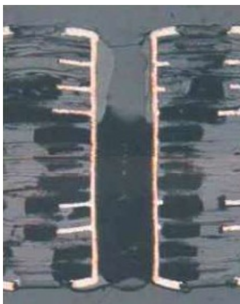
Рис. 3. Фото металлографического шлифа металлизированного отверстия многослойной печатной платы после имитации условий пайки
