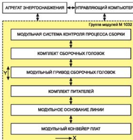
Рис. 1. Структура линий SMD-сборки семейства М 1032
