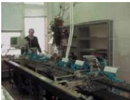
Рис. 2. Линия SMD-сборки М 1032
