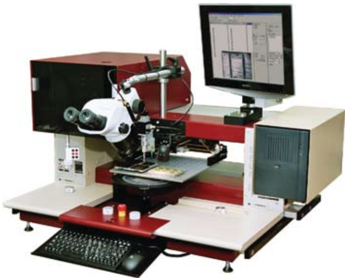
Рис. 3. Полуавтоматическая установка монтажа кристаллов T-3202
