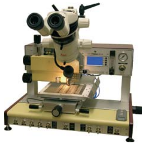
Рис. 4. Установка демонтажа присоединенных кристаллов T-Chipex 1
