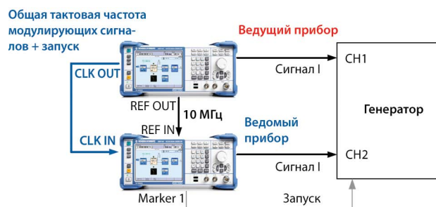
Рис. 3. Схема измерения временного согласования модулирующих сигналов
