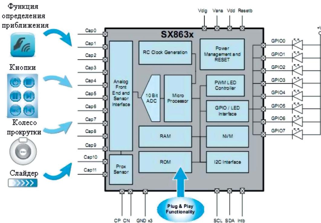
Рис. 1. Структурная схема контроллера серии SX863x
