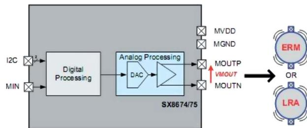
Рис. 4. Функциональная схема встроенного драйвера LRA и ERM
