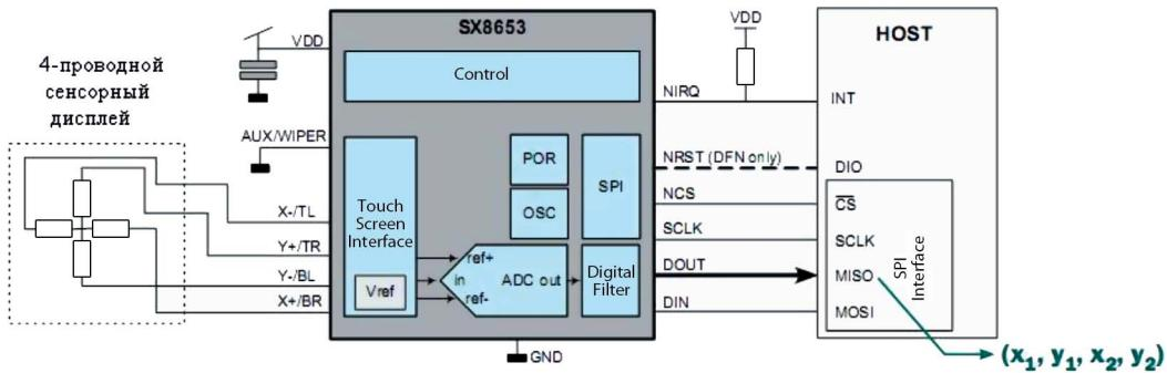
Рис. 3. Структурная схема контроллера SX8653
