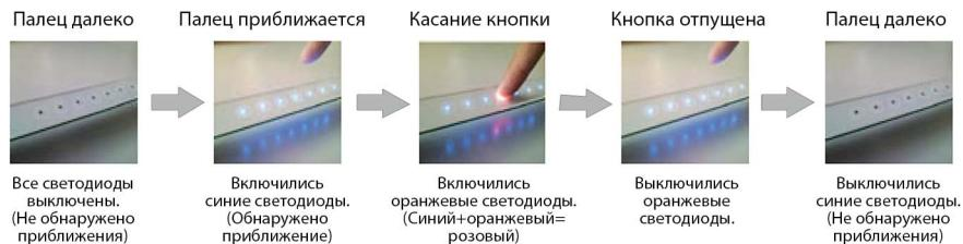
Рис. 2. Алгоритм работы встроенных светодиодных драйверов
