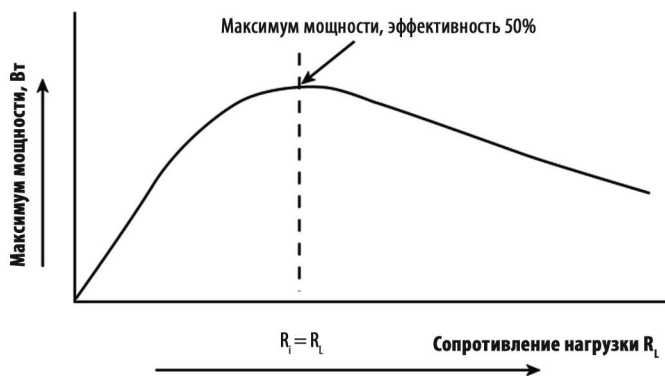
Рис. 2. При согласовании импедансов нагрузки и источника обеспечивается максимум мощности в нагрузке
