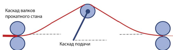
Рис. 1. Схема технологического процесса прокатки стали
