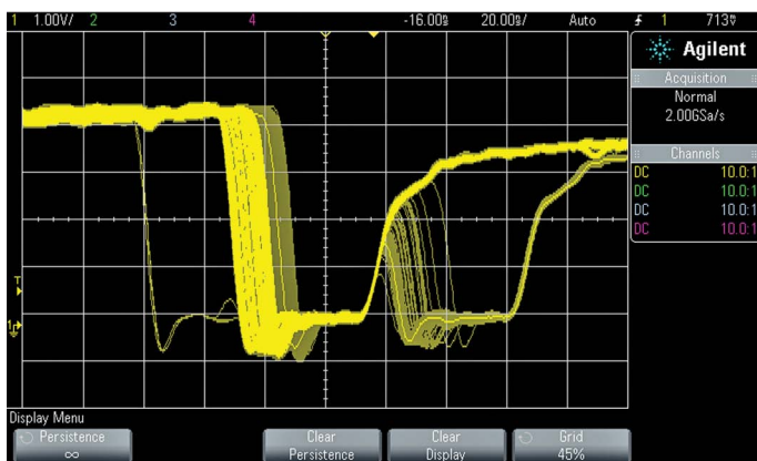
Рис. 3. На осциллограмме видны джиттер и редко происходящие импульсные помехи. Захват выполнен осциллографом Agilent InfiniVision серии 3000 X в течение 1 с при скорости обновления сигналов 1 млн осциллограмм в секунду
