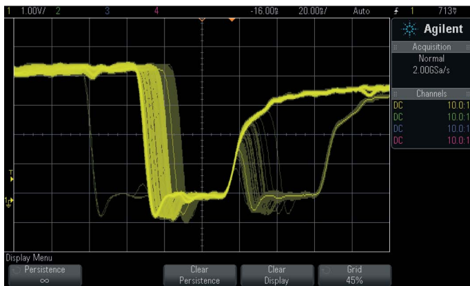
Рис. 2. Иллюстрация градаций яркости. Обратите внимание, что некоторые участки осциллограммы ярче, чем другие. Это те участки, на которых отсчёты входного сигнала отображаются статистически чаще, чем на более тусклых
