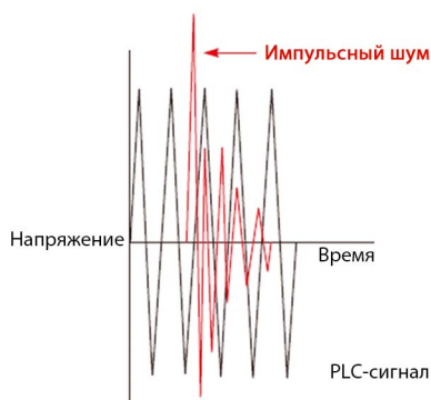
Рис. 2. Импульсный шум в линии электропередачи непредсказуем и может привести к уничтожению любых совпадающих пакетов данных
