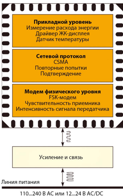
Рис. 6. В состав PLC-устройства CY8CPLC20 от Cypress входят модем физического уровня, сетевой протокол и прикладной уровень
