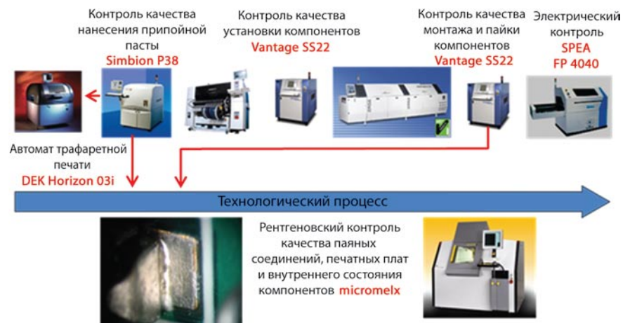
Рис. 1. Применение локальных петель обратной связи позволяет сократить время реакции и минимизировать количество технологических дефектов, связанных с неудовлетворительным количеством припоя в паяных соединениях
