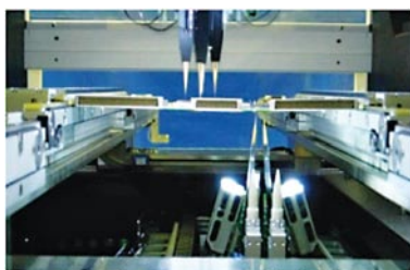
Рис. 9. Входной контроль печатных плат повышает качество и надёжность выпускаемой продукции и снижает риск
