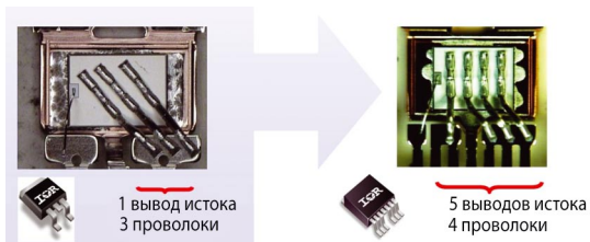
Рис. 6. Новый корпус обеспечивает удвоение токовой нагрузочной способности до двух раз
