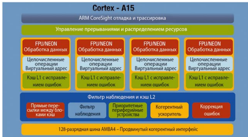
Рис. 2. Структура ядра Cortex-A15
