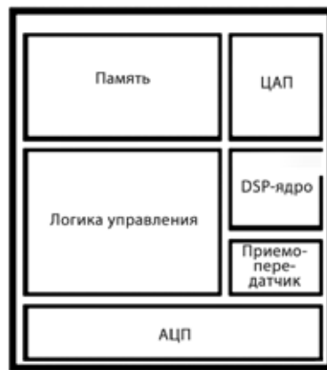
Рис. 4. Топология кристалла, созданная при «ручном» проектировании аналоговых схем
