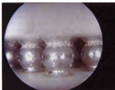
Рис. 4. Отсутствие проседания микросхемы во время пайки из-за ненадежного соединения шариковых выводов с контактными площадками
