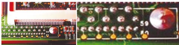
Рис. 2. Применение компонентов, монтируемых в отверстия печатной платы, с различными диаметрами и массой выводов создают, на первый взгляд, неразрешимую проблему повторяемости параметров технологического процесса пайки для каждого паяного соединения, необходимой для обеспечения высокого уровня качества и надёжности выпускаемой продукции. Для обеспечения высокого уровня автоматизации технологического процесса пайки печатных узлов со смешанным двухсторонним монтажом компонентов необходимы новые технологии и оборудование
