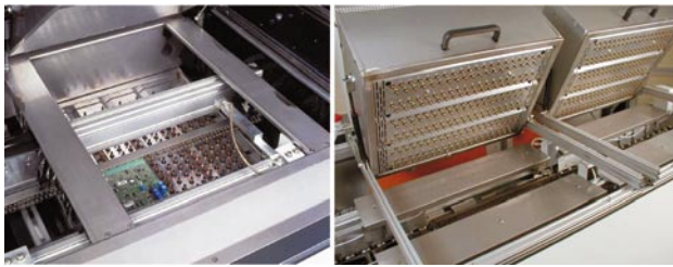
Рис. 7. Патентованная система предварительного нагрева снизу и сверху конвекционными модулями MultiJet обеспечивает равномерный нагрев печатных узлов, не допуская перегрева термочувствительных компонентов. Рекомендуется для флюсов с низким содержанием летучих органических соединений (VOC free)
