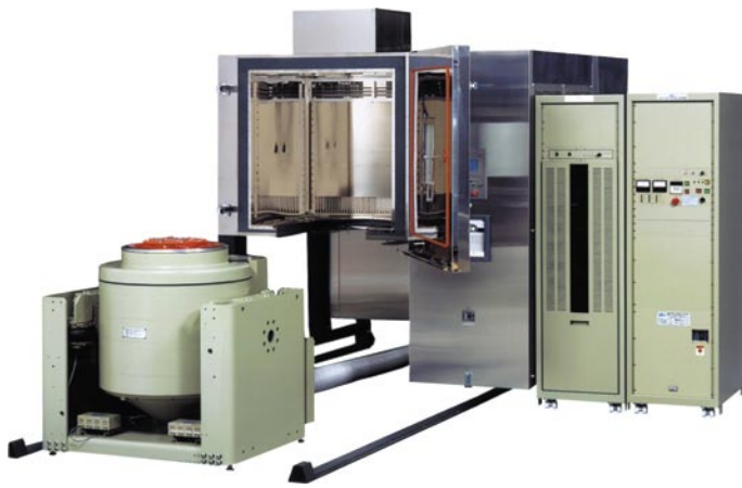
Рис. 2. Комбинированная установка (компания EMIC Corporation, Япония). Воспроизводимые факторы воздействия: вибрация, температура, термоудар/термоциклирование, влажность
