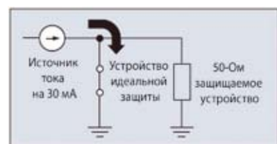
Рис. 3. При возникновении опасных скачков тока или напряжения «идеальное» устройство защиты превращается в короткозамкнутую на землю линию, что защищает нагрузку
