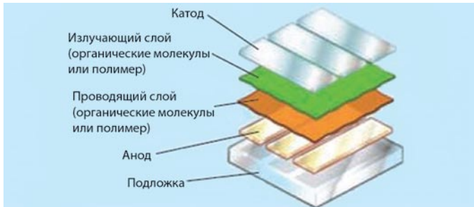
Рис. 2. Структура органического светодиода
