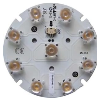
Рис. 3. Простой светодиодный модуль от Future Lighting Solutions, с некоторыми ключевыми аспектами дизайна, влияющими на повышение его надежности, а именно: Электрическая схема
