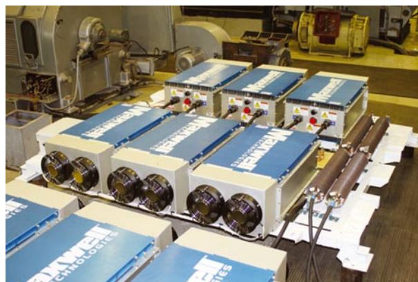
Рис. 6. Буферный накопитель — батарея суперконденсаторов Maxwell, 21 Ф, 750 В
