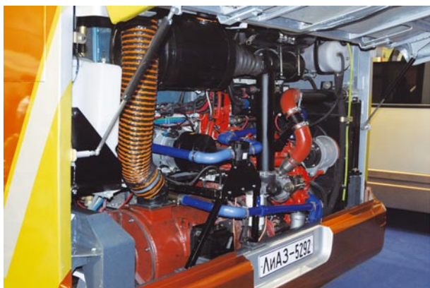
Рис. 5. Расположение ДВС, МГ и ТАД на автобусе
