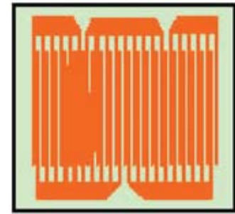
Ширина проводника 0,318 мм. Шаг между проводниками 0,318 мм. Длина нахлеста 15,75 мм.
