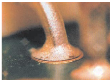
Рис. 4. Отрыв (подъем) кромки (шва) контакта при волновой пайке из-за включений свинца
