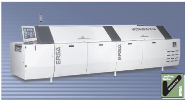
Рис. 7. Современная система конвекционного оплавления серии HotFlow 3 компании Ersa, Германия, обеспечивает необходимую производительность для производства любой серийности при гарантии повторяемости заданных параметров температурного профиля
