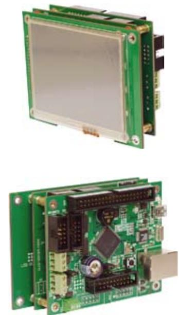
рис. 5. Микроконтроллерная система на основе TE-ULCD35 и TE-STM32F107
