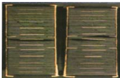
Рис. 7. Соответствующая трещина в ламинате
