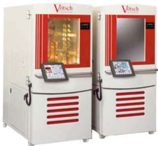
Рис. 1. Температурная и климатическая камеры VT3 7034/VC3 7034
