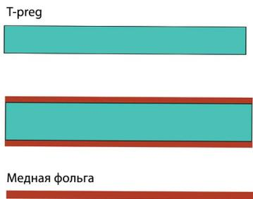
Рис. 4. Конструкция печатной платы с использованием T-preg
