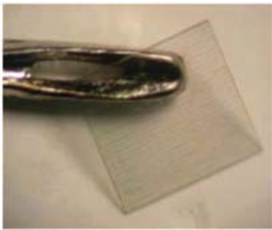
Рис. 5. Отделенная от подложки GaN-фольга (Публикуется с разрешения компании Goldeneye)
