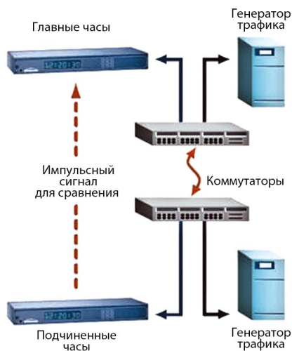
Рис. 4. Схема для измерения задержки, вносимой двумя коммутаторами
