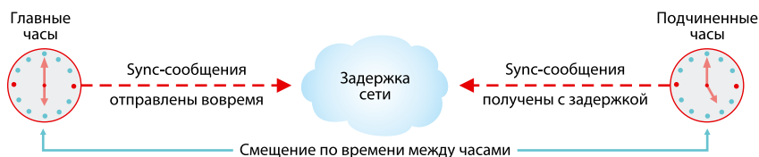
Рис. 1. Задержка распространения сигнала между двумя устройствами
