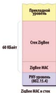
Рис. 7. Готовое решение ZigBee в сравнении с заказными MAC-уровнем и стеками
