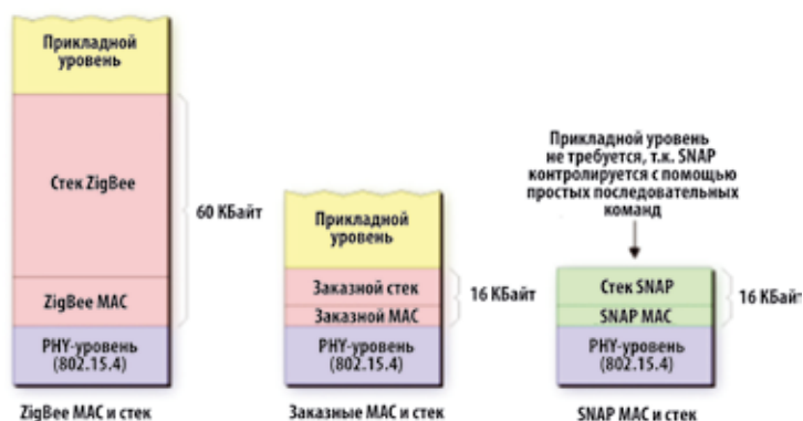
Рис. 8. Сеть ZigBee в сравнении с заказным решением и SNAP MAC и стеками
