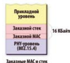
Рис. 7. Готовое решение ZigBee в сравнении с заказными MAC-уровнем и стеками
