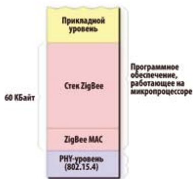
Рис. 6. ZigBee MAC-уровень и стек ZigBee
