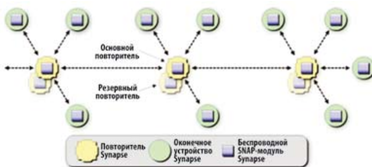
Рис. 11. Высоконадежная SNAP-сеть с древовидной топологией
