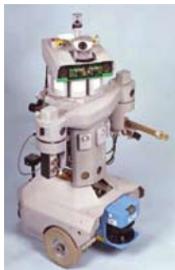
рис. 6. Разведывательный робот ROBART III на базе CM-i686, предназначенный для обнаружения взрывчатых веществ
