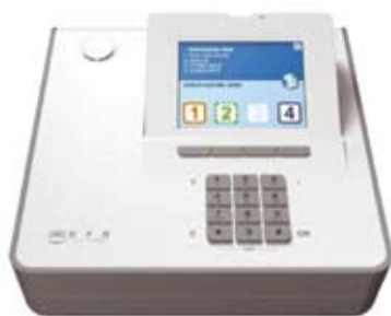
рис. 8. Plenitude Premium — система обнаружения вторжения в помещении на базе SBC-X255
