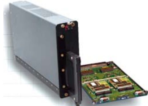
рис. 3. Вычислитель управления полетом ОАО «КБПА» на базе CM-F82
