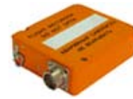
рис. 2. Малогабаритный спасаемый бортовой накопитель (МСБН) на базе CM-1686B
