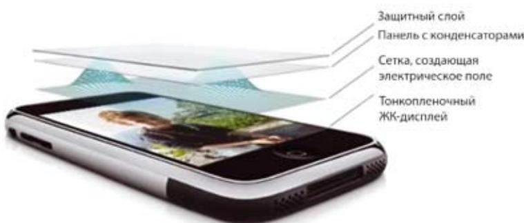
Рис. 2. Структура емкостного сенсорного дисплея
