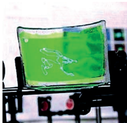
Рис. 10. Прозрачный гибкий OLED в диапазоне зеленого света
